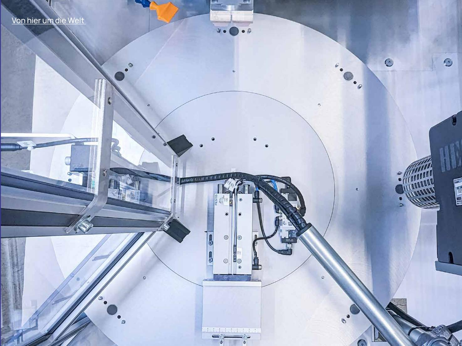
Teca-Print produziert seit 50 Jahren Tampondruckmaschinen und kundenspezifische Drucksysteme - voll automatisiert. Das Bild zeigt einen Schalttisch für die Bedruckung.
